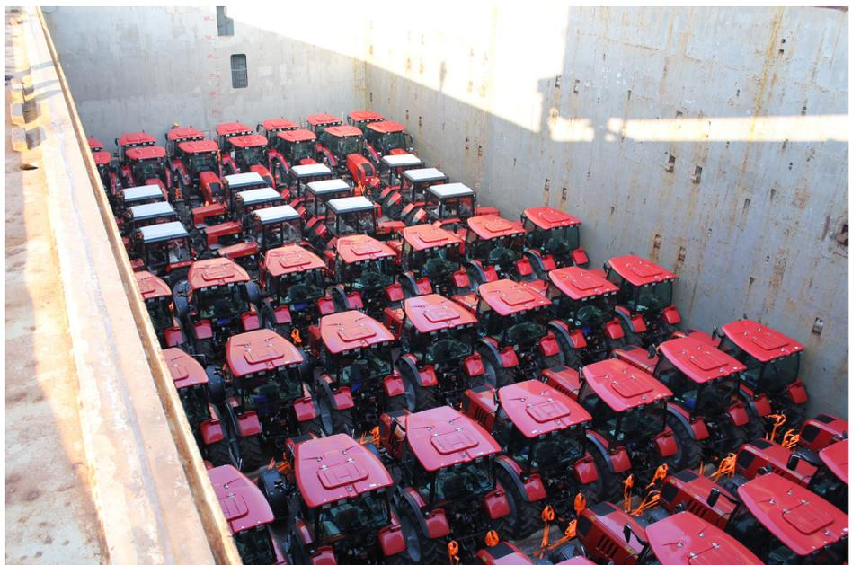
\*Сухогруз или сухогрузное судно – грузовое судно речного или морского базирования, приспособленное для перевозки различных сухих грузов, например, сыпучих грузов, зерна, леса, щепы, минеральных удобрений, специальных контейнеров международного стандарта и других грузов. Часто оснащается двойным дном и бортами для повышения безопасности плавания.
